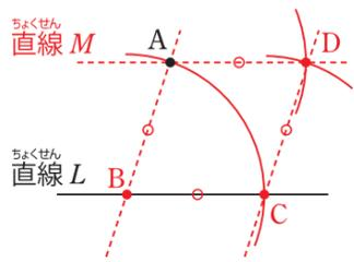
次に、直線LとL上ない点Aが与えられているときの、Aを通りLと垂直な直線Mの描き方です。点Aを中心とする円を1つ描き、その円と直線Lとの交点をB、Cとします。点Bを中心とする半径BCの円と点Cを中心とする半径BCの円を描き、それら2円の交点のうち1つをDとします。そして、2点AとDを通る直線を描けば、その直線がAを通りLと垂直な直線Mになるのです。
