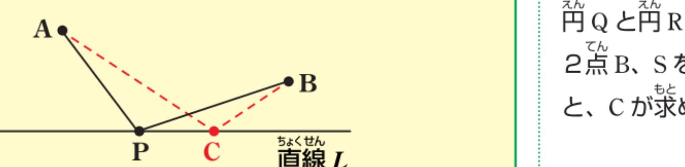
**描き方** 点Aを中心とし直線 $L$ と2点で交わるように円Aを描き2つの交点をQ、Rとします。Qを中心とし半径AQの円QとRを中心とし半径ARの円Rを描き、円Qと円Rの交点のうちAではない方をSとします。2点B、Sを通る直線を描き、直線BSと直線 $L$ の交点をCとすると、Cが求める点になっています。
